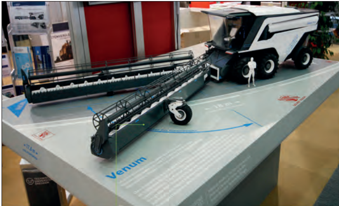
Umsetzung des neuartigen Maschinenkonzepts in einem Präsentations-Modell im Maßstab 1:10 (1800x1800mm)
